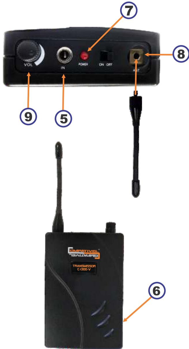
Abra a parte lateral do bodypack (6), a tampa do compartimento de pilhas se abrirá, levante a tampa, coloque as pilhas de acordo com a polaridade. Coloque a antena em seu local indicado (8) e a rosqueie até travar. Conecte o cabo P2 ao bodypack (5) e logo após ao seu instrumento. Ligue o bodypack, o led (luz) vermelha ficará aceso (7) indicando estado normal de operação, se nada ocorrer, verifique se a pilha foi inserida corretamente. Ajuste o volume (9) na posição desejada.
